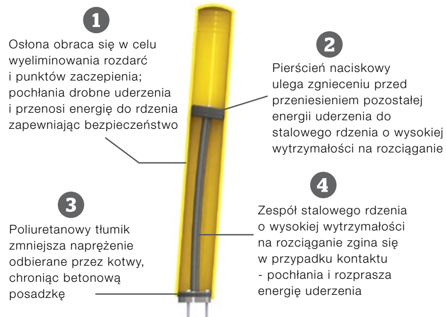
Konstrukcja pochłaniająca uderzenia - bez wgnieceń, bez potrzeby ponownego malowania.
